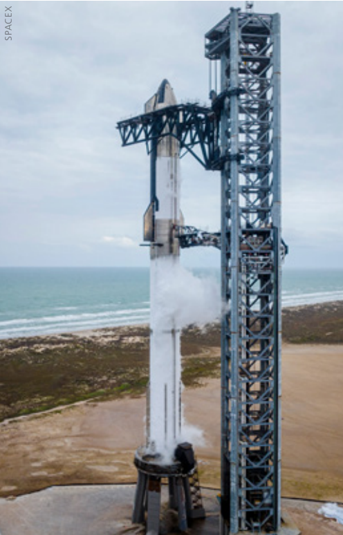
Das voll betankte Starship beim Wet Dress Rehearsal. Wegen der Kälte bildet sich Frost auf der Außenhaut der Rakete.
